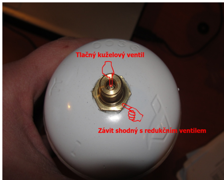
Obrázek 7: Konstrukce ventilu plynové kartuše s héliem
