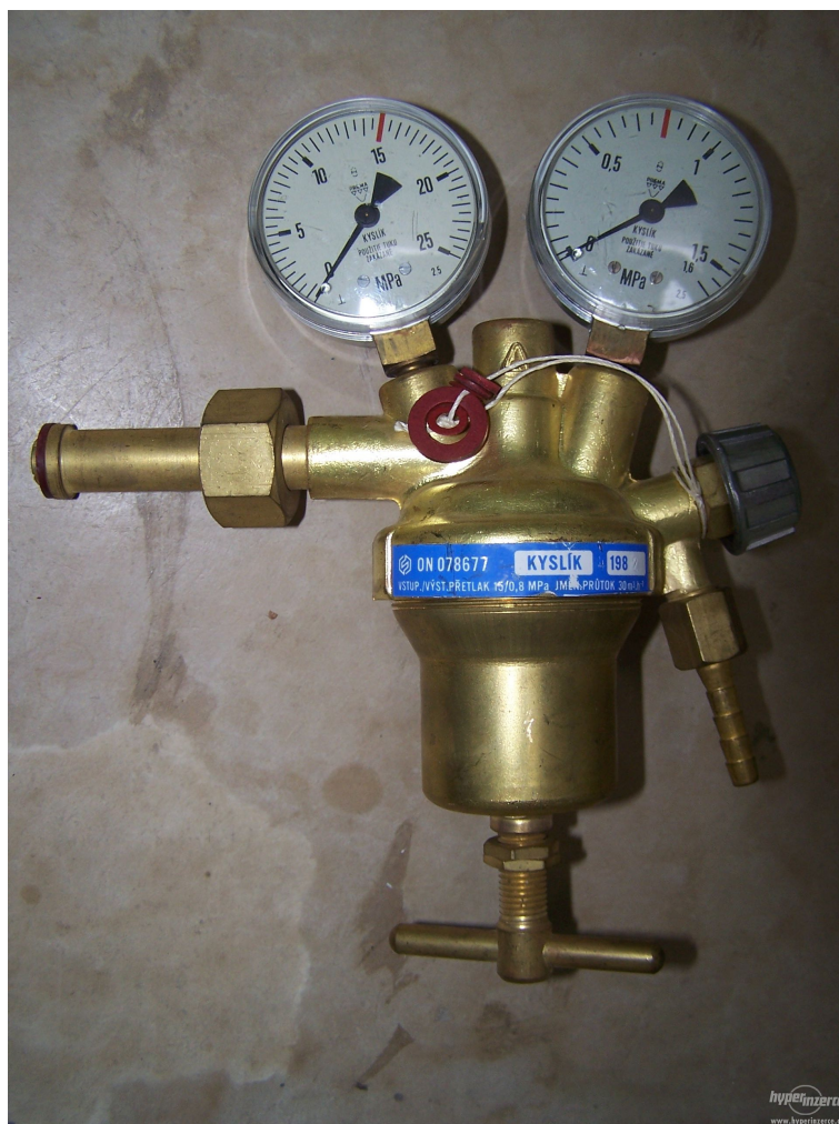
Obrázek 11: Redukční ventil na kyslík sloužící jako náhrada za vodíkový redukční ventil s levým závitem
