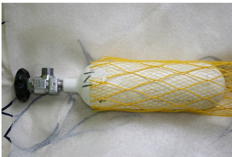
Obrázek 9: Znovuplnitelná lahev na technické plyny
