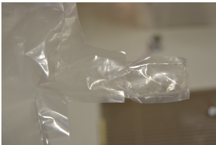
Obrázek 16: Zpětný ventil v nohavici balónu - foto
