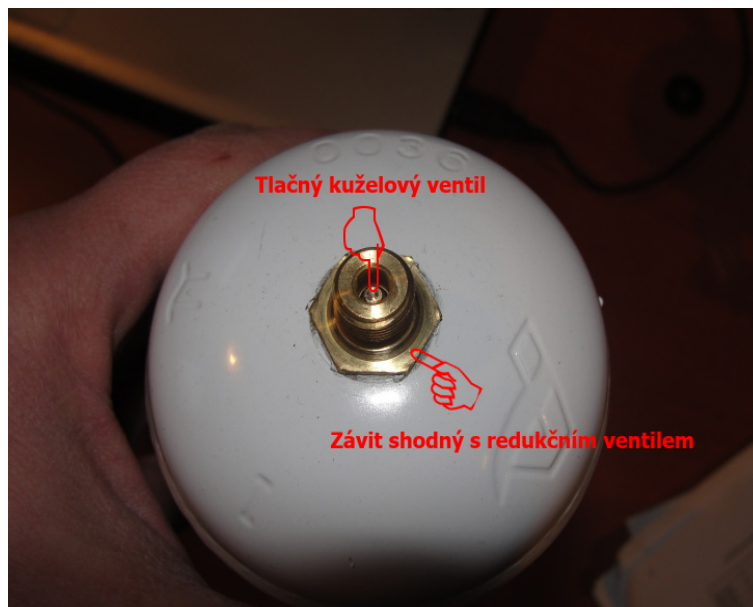
Obrázek 7: Konstrukce ventilu plynové kartuše s héliem
