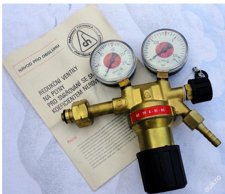
Obrázek 10: Redukční ventil na vodík - tento ventil byl pořízen s očekáváním lepších parametrů, než ventil kyslíkový, má však ale levý závit. (Jako všechny ventily pro hořlavé plyny splňující normu)
