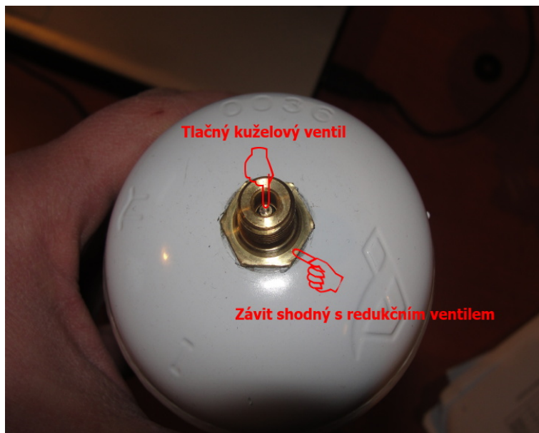
Obrázek 7: Konstrukce ventilu plynové kartuše s héliem
