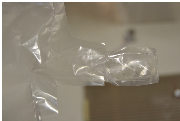
Obrázek 16: Zpětný ventil v nohavici balónu - foto
