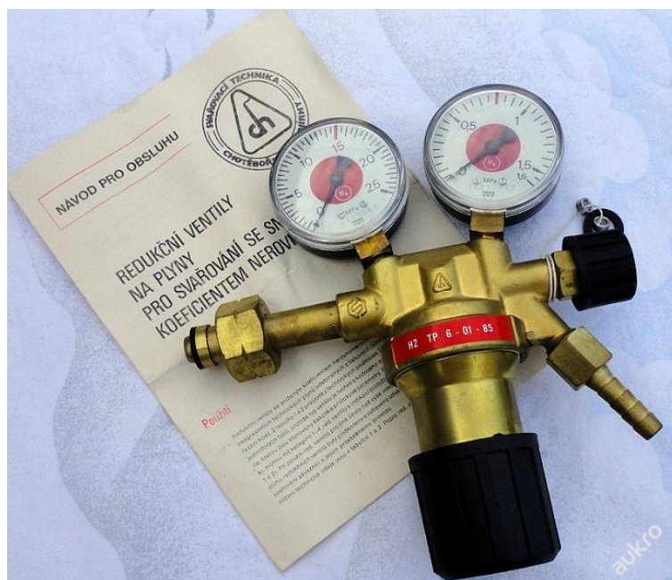
Obrázek 7: Redukční ventil na vodík - tento ventil byl pořízen s očekáváním lepších parametrů, než ventil kyslíkový, má však ale levý závit. (Jako všechny ventily pro hořlavé plyny splňující normu)
