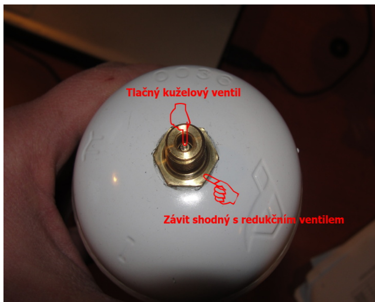
Obrázek 5: Konstrukce ventilu plynové kartuše s héliem
