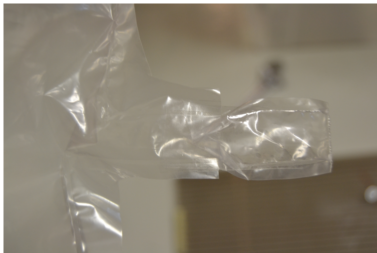
Obrázek 6: Zpětný ventil v nohavici balónu - foto
