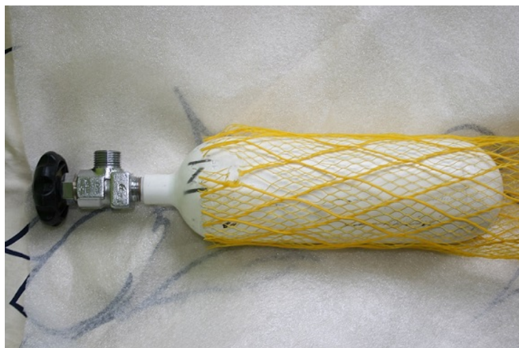
Obrázek 10: Znovuplnitelná lahev na technické plyny
