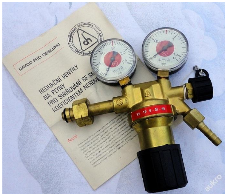
Obrázek 11: Redukční ventil na vodík - tento ventil byl pořízen s očekáváním lepších parametrů, než ventil kyslíkový, má však ale levý závit. (Jako všechny ventily pro hořlavé plyny splňující normu)
