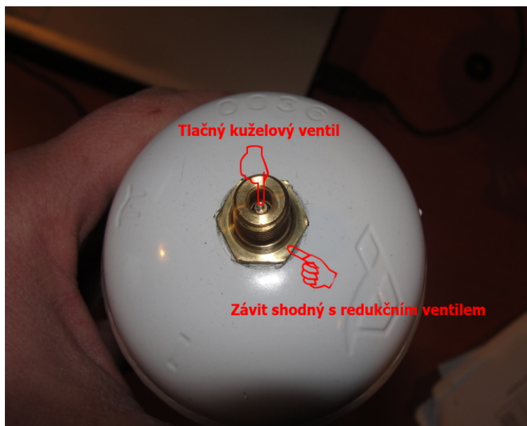
Obrázek 4: Konstrukce ventilu plynové kartuše s héliem
