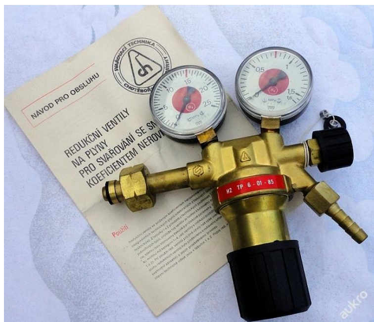
Obrázek 12: Redukční ventil na vodík - tento ventil byl pořízen s očekáváním lepších parametrů, než ventil kyslíkový, má však ale levý závit. (Jako všechny ventily pro hořlavé plyny splňující normu)
