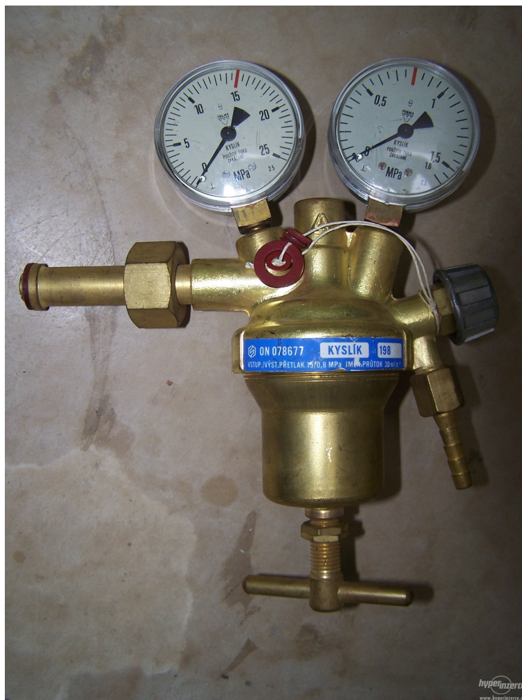
Obrázek 13: Redukční ventil na kyslík sloužící jako náhrada za vodíkový redukční ventil s levým závitem
