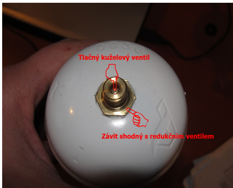
Obrázek 9: Konstrukce ventilu plynové kartuše s héliem
