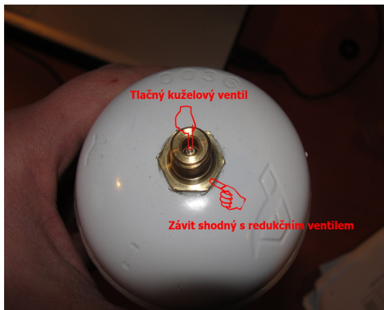
Obrázek 4: Konstrukce ventilu plynové kartuše s héliem
