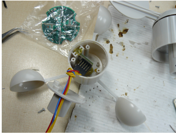
Obrázek 2: Modifikovaný anemometr s magnetickým snímačem MAG01A
