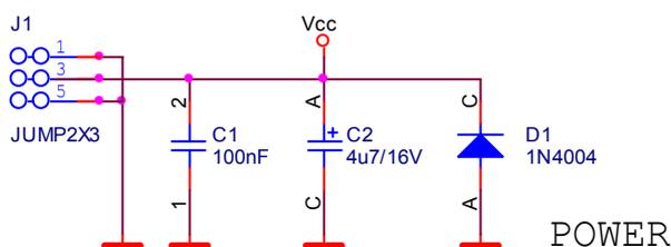
Dioda D1 je ochranná dioda proti přepólování napájení.
