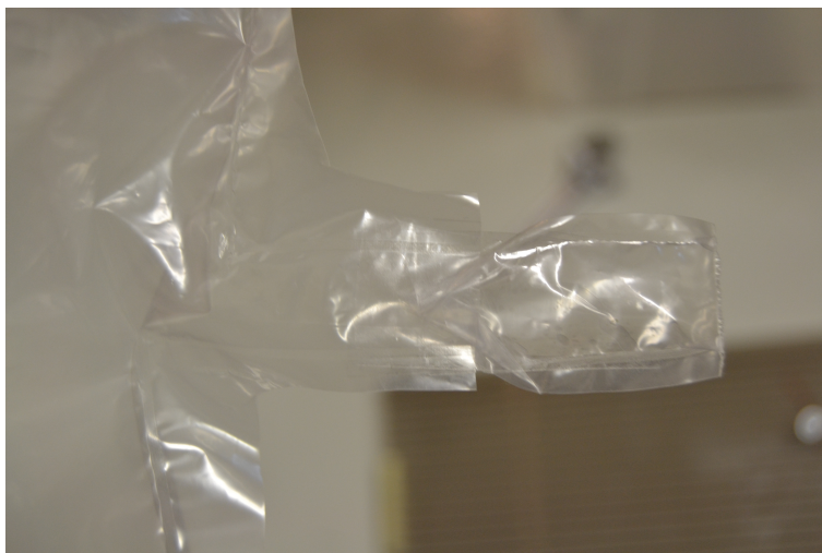
Obrázek 15: Zpětný ventil v nohavici balónu - foto
