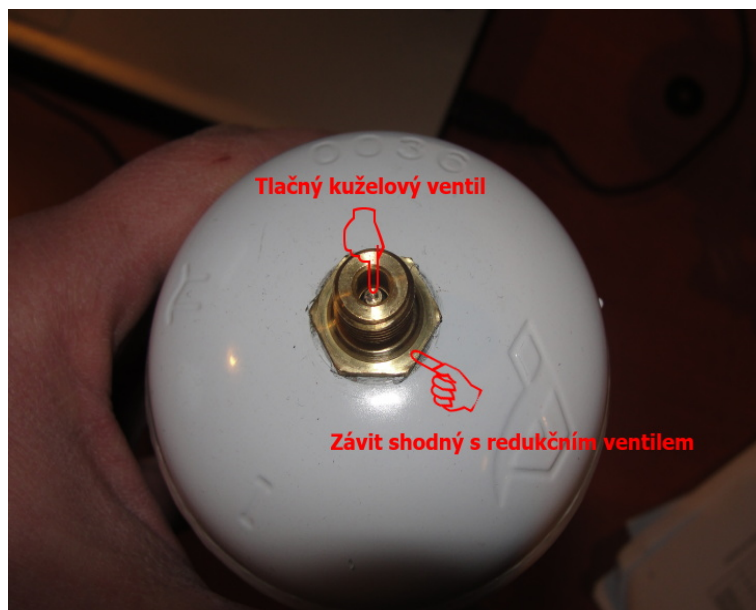
Obrázek 5: Konstrukce ventilu plynové kartuše s héliem
