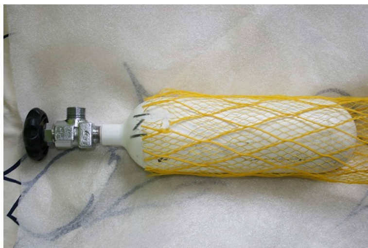
Obrázek 7: Znovuplnitelná lahev na technické plyny
