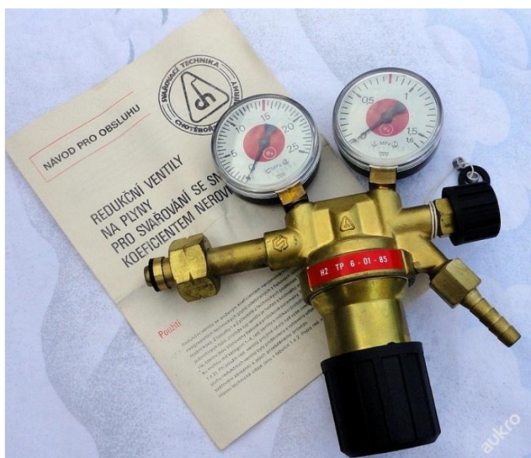
Obrázek 8: Redukční ventil na vodík - tento ventil byl pořízen s očekáváním lepších parametrů, než ventil kyslíkový, má však ale levý závit. (Jako všechny ventily pro hořlavé plyny splňující normu)
