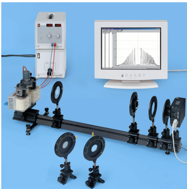
Obrázek 11: Experimentální sestava s CCD kamerou a sběrem dat přes PC. Kamera má sejmutý objektiv a barevný filtr je k ní umístěn tak blízko, že tvoří přirozené stínění pro všechny jiné vlnové délky než červené.
