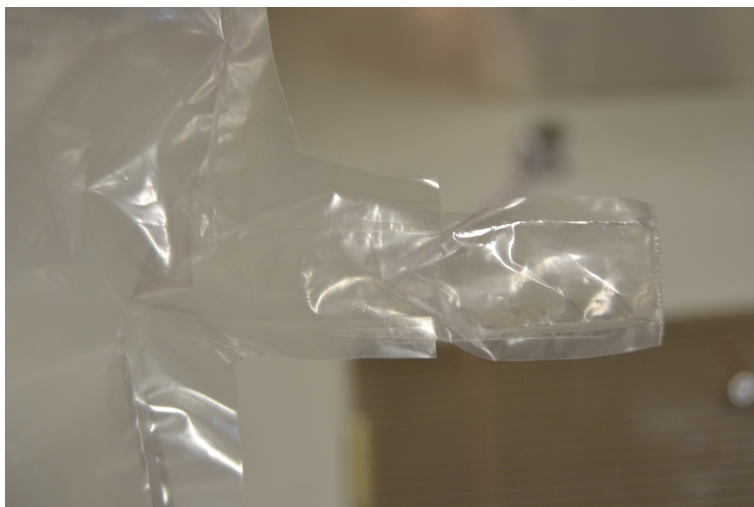
Obrázek 15: Zpětný ventil v nohavici balónu - foto
