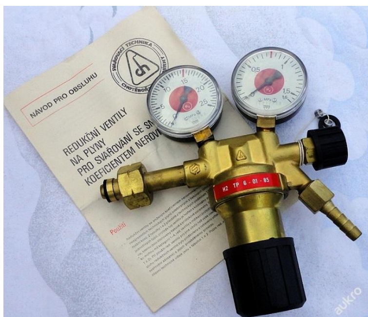
Obrázek 9: Redukční ventil na vodík - tento ventil byl pořízen s očekáváním lepších parametrů, než ventil kyslíkový, má však ale levý závit. (Jako všechny ventily pro hořlavé plyny splňující normu)
