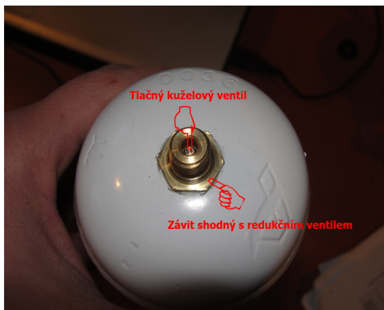
Obrázek 6: Konstrukce ventilu plynové kartuše s héliem
