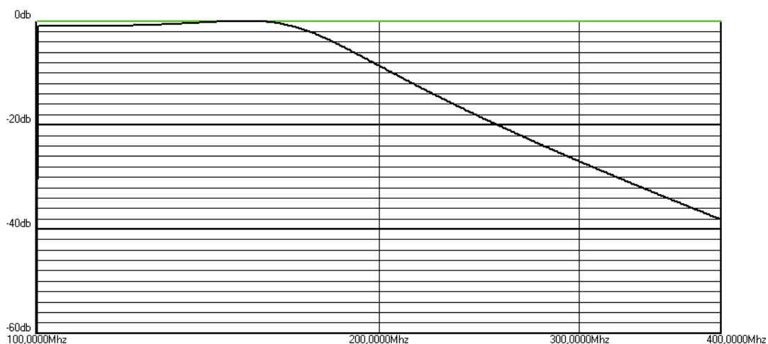
Obr. 24: Graf závislosti útlumu výstupního filtru na kmitočtu vypočtený v AADE Filter Design
