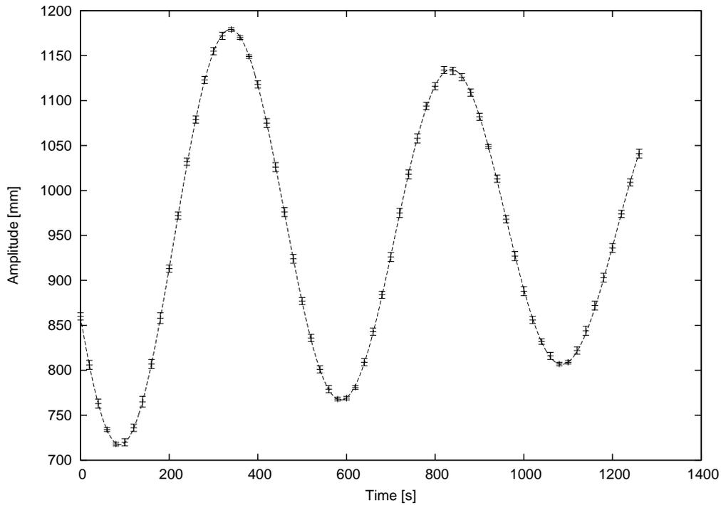
Obrázek 1: Casový průběh výchylky torzního kyvadla v 1. pozici koulí.
