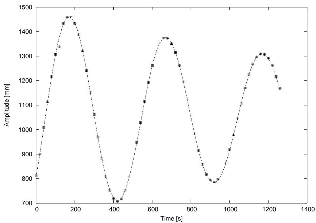
Obrázek 2: Casový průběh výchylky torzního kyvadla v 2. pozici koulí.
