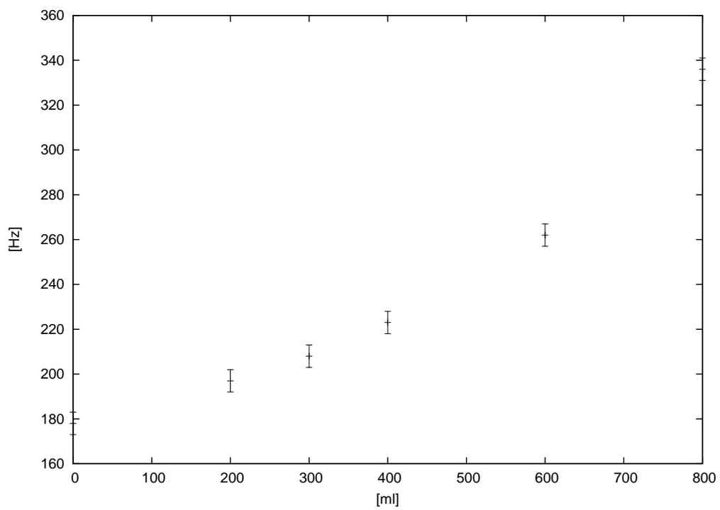
Obrázek 3: Závislost rezonanční frekvence Helmholtzova oscilátoru na objemu vlité vody
