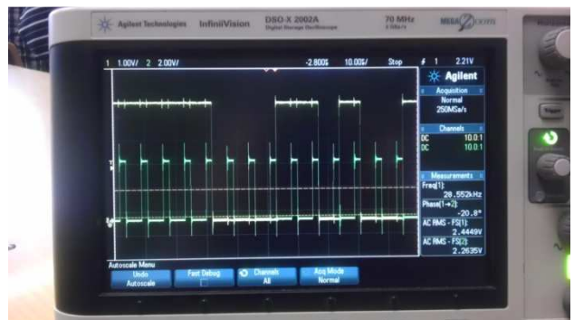
Test funkčnosti optického řádkového senzoru (vlevo) a detail průběhu (vpravo)
