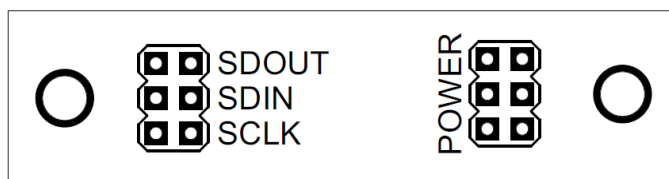
Osazení modulu OLSA01A - svrchní strana
