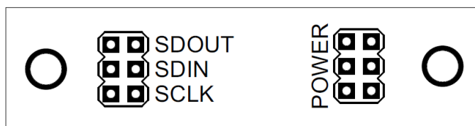
Osazení modulu OLSA01A - svrchní strana
